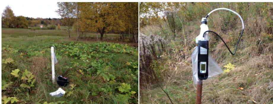
Figur 8. Mätning med Dräger X-am 5600 inom området i tidigare installerade grundvattenrör av plast (Gas2:3) och i 1-tums grundvattenrör av stål (Gas2:7)
