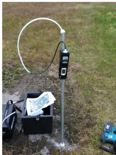
Figur 9. Metangasmätning under betonglock i befintlig brunn (Gas2:8) samt i installerat porgasspjut (Gas2:9).
