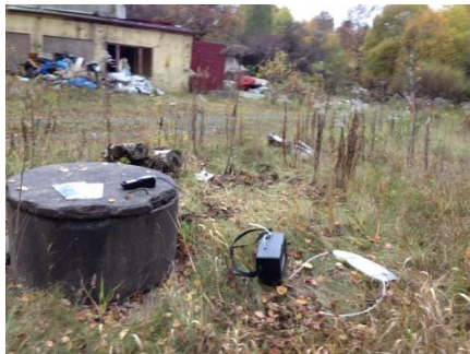
Figur 9. Metangasmätning under betonglock i befintlig brunn (Gas2:8) samt i installerat porgasspjut (Gas2:9).
