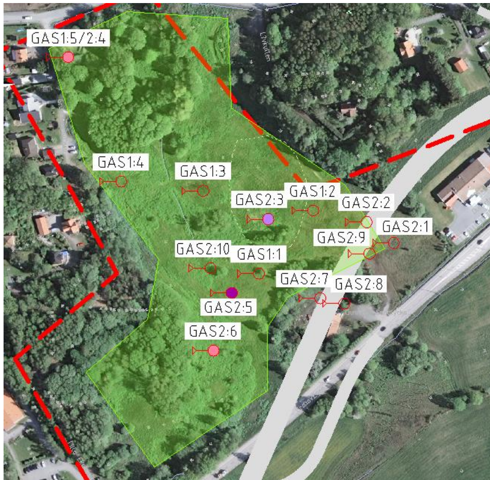
Figur 11. Situationsplan över utförd deponigasmätning inom Janssons grop vilken är markerad med transparent grön färg (uppskattat läge från äldre kartmaterial).
