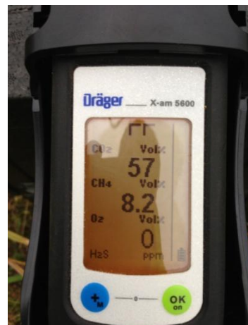
Figur 12. Mätning av deponigas i befintligt grundvattenrör av stål (Gas2:5) inom Janssons grop. Uppmätt metanhalt 57 vol%.
