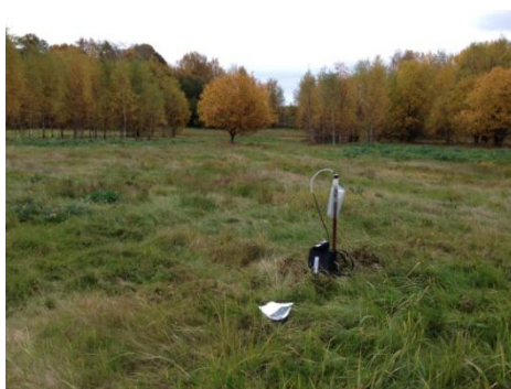
Figur 12. Mätning av deponigas i befintligt grundvattenrör av stål (Gas2:5) inom Janssons grop. Uppmätt metanhalt 57 vol%.
